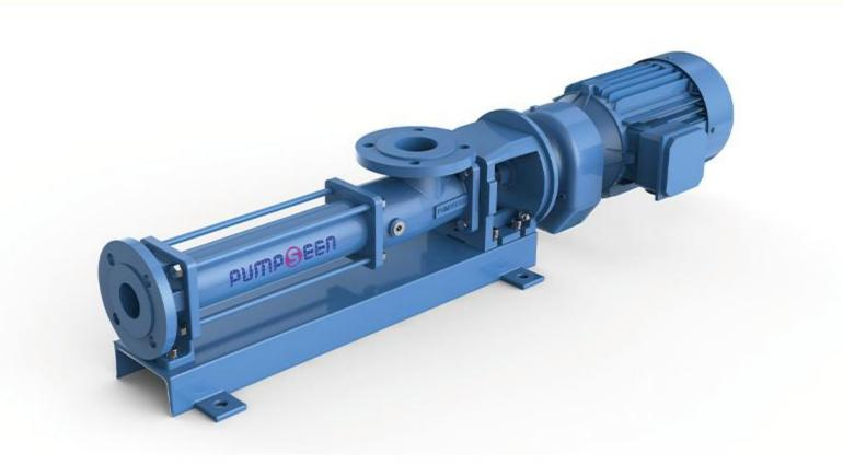
螺杆泵(单螺杆泵)是一种内啮合的密闭式螺杆泵,属转子式容积泵。主要工作部件由具有双头螺旋空腔的定子和在定子孔内与其啮合的单头螺旋螺杆即转子组成。
